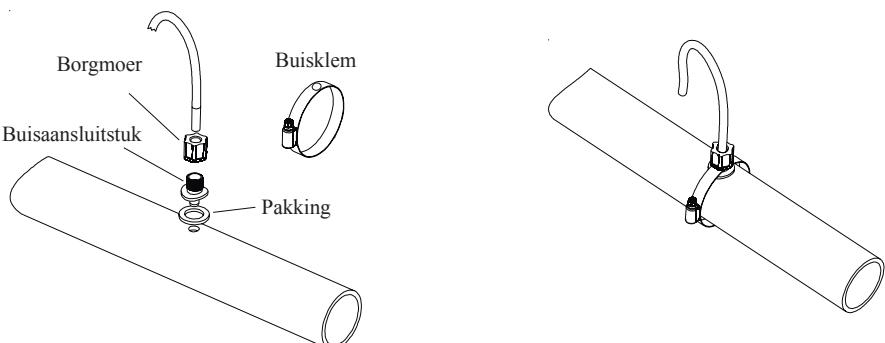
Leid de flexibele buis van het buisaansluitstuk naar de toevoeropening van de sondecel. Duw de flexibele buis helemaal in het drukaansluitstuk zodat ze in de opening geplaatst wordt.
