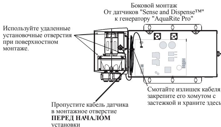
**Дистанционный поверхностный монтаж датчиков "Sense and Dispense™":** Измерительный блок можно смонтировать на расстоянии до 4,4 м от генератора "AquaRite Pro" (в зависимости от длины кабеля). При поверхностном монтаже воспользуйтесь четырьмя установочными отверстиями на обратной стороне кронштейна. В большинстве случаев можно использовать для этой цели шурупы.
