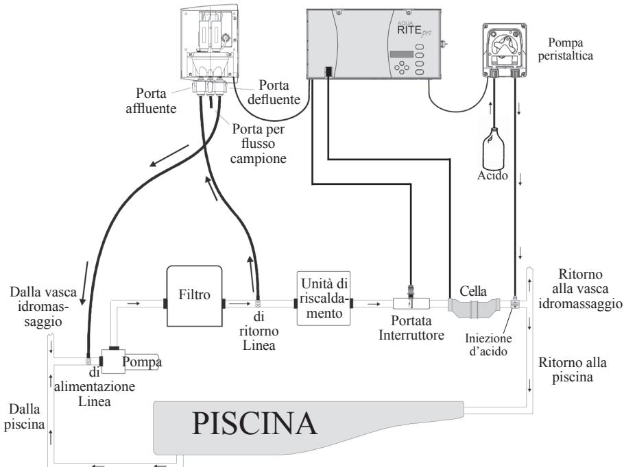
**Installazione dei raccordi sulla linea di ritorno:** realizzare un foro da 10 mm sulla linea di ritorno del sistema idraulico appena a valle del filtro, ma a monte della cella elettrolitica. Posizionare la guarnizione sul raccordo e inserire quest'ultimo nel foro, come mostrato di seguito. Stringere il raccordo con l'apposita pinza. Una volta effettuata l'operazione, inserire il tubo flessibile nel raccordo e stringere manualmente il dado di ritegno in plastica.
