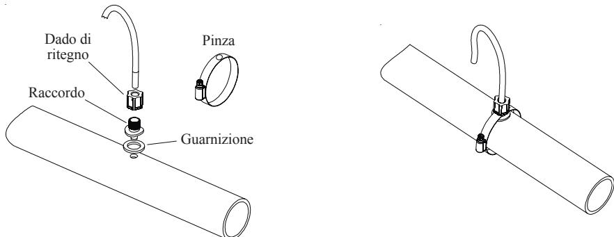
Far scorrere il tubo flessibile dal raccordo alla porta affluente della cella. Spingere il tubo flessibile lungo il percorso all'interno del raccordo a pressione fino a raggiungere la porta.
