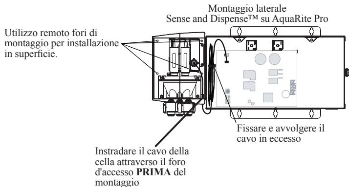
**Montaggio in superficie del kit Sense and Dispense™:** la cella può essere installata a una distanza massima di 4,4 m dall'unità AquaRite Pro (limite dovuto dalla lunghezza del cavo). Utilizzare i quattro fori di montaggio sul retro del supporto. È possibile utilizzare per l'operazione viti comuni.
