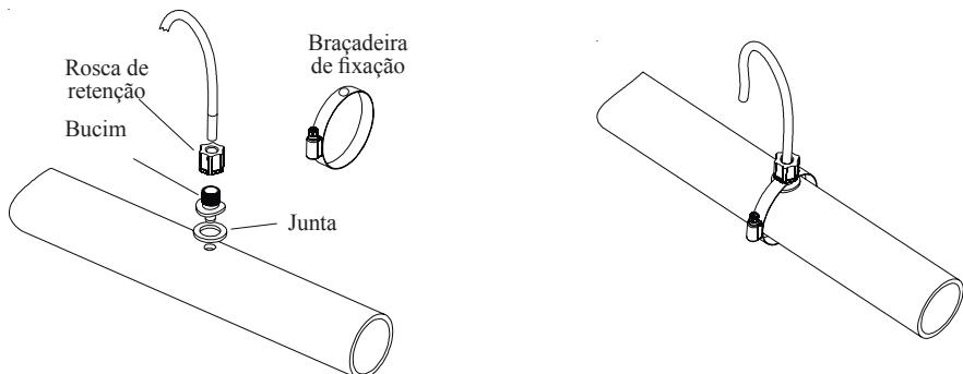
Leve o tubo flexível do bucinim ao orifício afluente da célula de detecção. Pressione totalmente o tubo flexível no bucinim para o encaixar no orifício.
