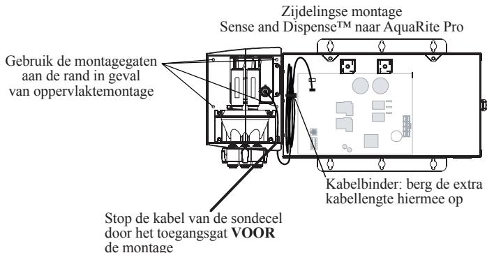
**Oppervlaktemontage op afstand van de Sense and Dispense™:** De sondecel kan op een afstand tot 4,4 m van de AquaRite Pro gemonteerd worden (beperkt door de lengte van de kabel). Gebruik de vier montagegaten aan de achterzijde van de beugel in geval van oppervlaktemontage. Voor de meeste toepassingen kunnen standaard houtschroeven gebruikt worden.
