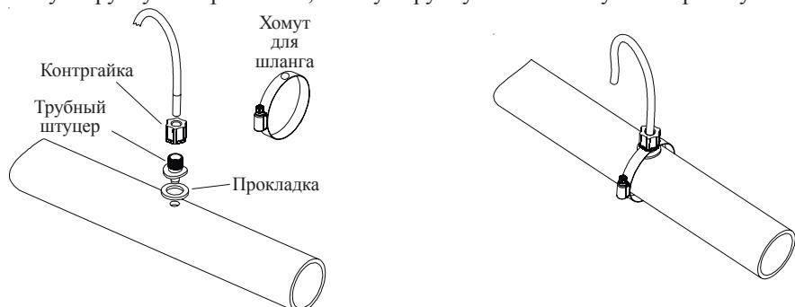
Протяните гибкую трубку от трубного штуцера до входного отверстия измерительного блока. Протолкните гибкую трубку до самого нагнетательного штуцера так, чтобы она плотно вошла в отверстие.
