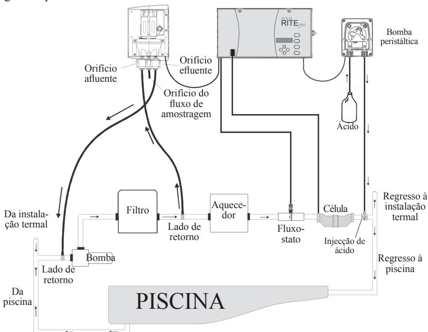
**Instalação do bucinim do lado de retorno:** Faça um furo de 10 mm no lado de retorno da tubagem da piscina numa área imediatamente a jusante do filtro, mas a montante da célula electrolítica. Instale a junta no bucinim e introduza o bucinim no furo, conforme ilustrado abaixo. Aperte o bucinim com a braçadeira de fixação fornecida. Com o bucinim bem fixo ao tubo da piscina, introduza firmemente o tubo flexível no bucinim e fixe-o ao apertar à mão a rosca de retenção de plástico.
