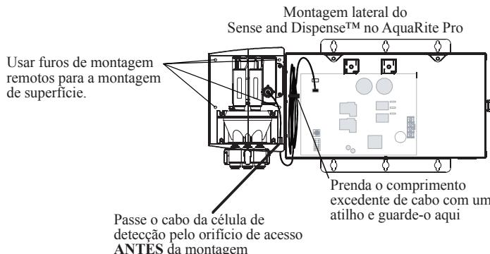
**Montagem remota de superfície do Sense and Dispense™:** A célula de detecção pode ser montada a uma distância de até 4,4 m do AquaRite Pro (limitado pelo comprimento do cabo). Utilize os quatros furos de montagem na parte posterior do suporte para a montagem de superfície. Podem ser utilizados parafusos comuns para madeira para a maioria das aplicações.
