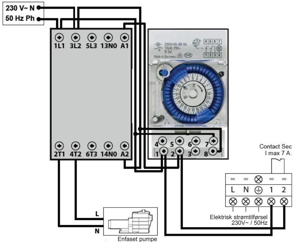
"Terminalene 1 og 2 gir et tørt kontaktpotensial uten polaritet 230 V~ / 50 Hz.
