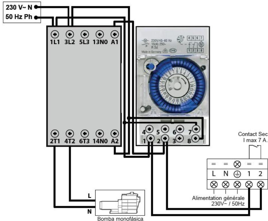
Los bornes 1 et 2 suministran un contacto seco (libre de potencial), sin polaridad de 230 V~ / 50 Hz. Conecte los cables a los bornes 1 y 2 respetando el esquema de cableado que se indica a continuación para que la bomba de filtración funcione por ciclos de 2 min cada hora en caso de que la temperatura de la piscina sea inferior al punto de consigna.
