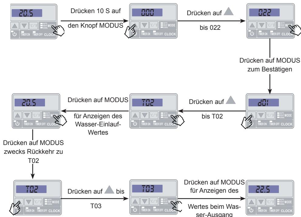
Dann Einstellen Ihres By-pass damit eine Temperatur-differenz von 2° C zwischen T03 und T02 ( $T_{03} - T_{02} = \Delta T = 2$ ) entsteht.
