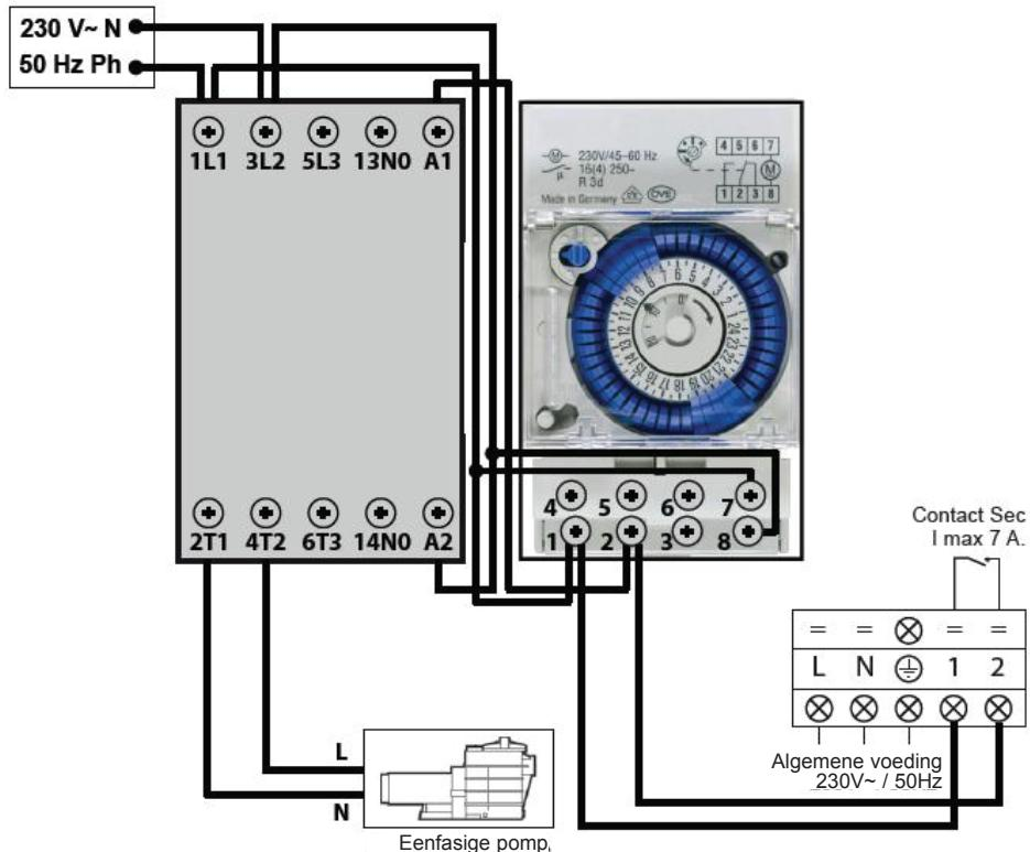
De zuilen 1-2 leveren een spanningvrij contact, zonder polariteit 230 V~ / 50 Hz.
