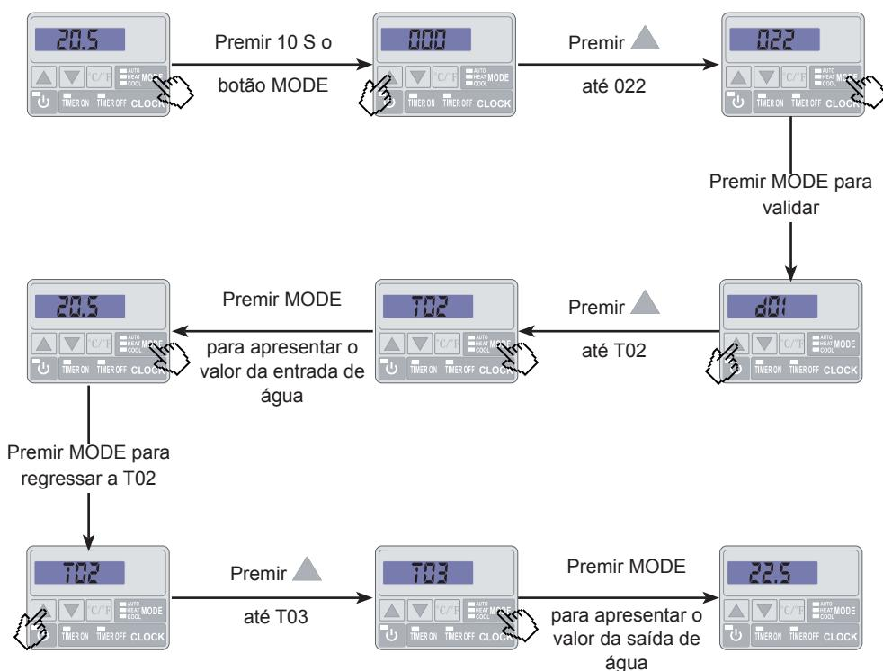
De seguida, regule o seu By-pass para obter uma diferença de 2° C entre T03 e T02 ( $T03 - T02 = \Delta T = 2$ ).
