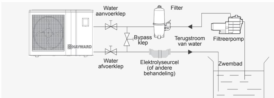
Noot : De warmtepomp wordt zonder enige behandelings- of filtreruitrusting geleverd. De elementen die op de chart staan zijn onderdelen die de installateur moet leveren.
