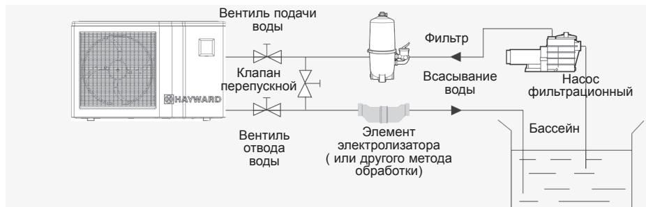
Примечание. Термический насос поставляется без какого-либо дополнительного оборудования для обработки или фильтрации воды. Представленные на схеме элементы поставляются фирмой, осуществляющей установку.
