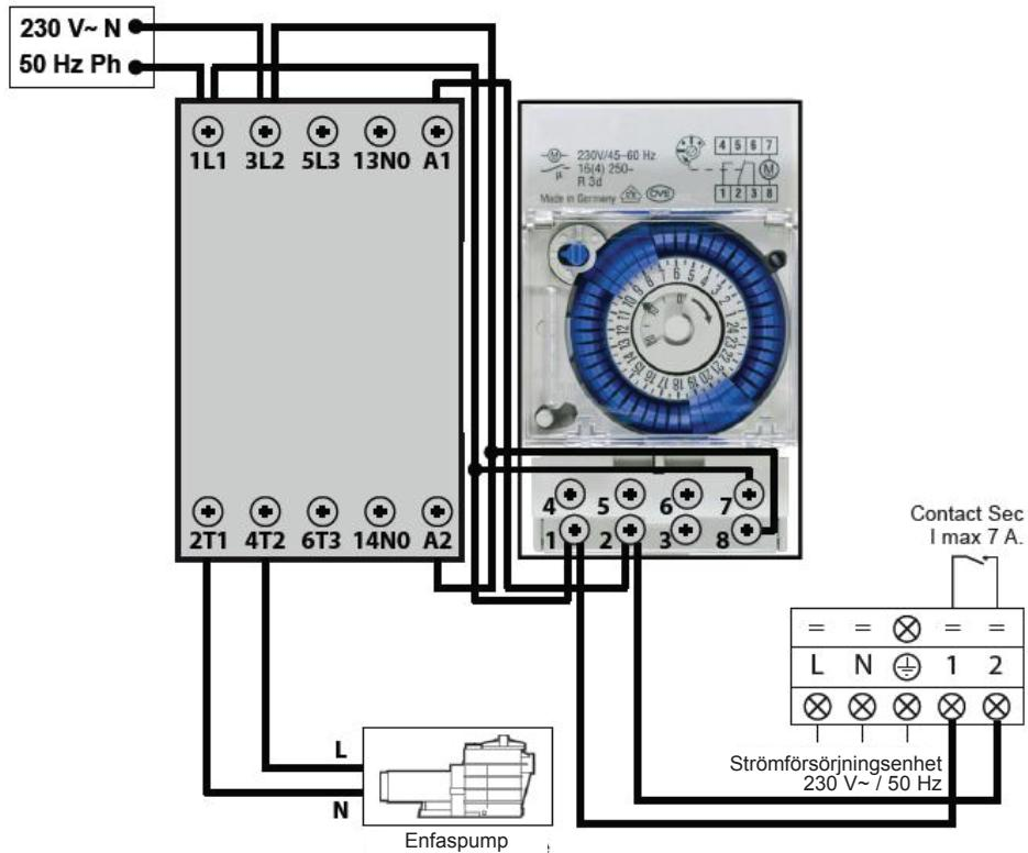
Utanför filtreringsintervallet är det nödvändigt att kontrollera vattentemperaturen genom en regelbunden start av filtreringspumpen (15 minuter varannan timme). Om värmepumpen efterfrågas under denna kontrollperiod kommer denna att starta och att behålla prioritet uppvärmning.
