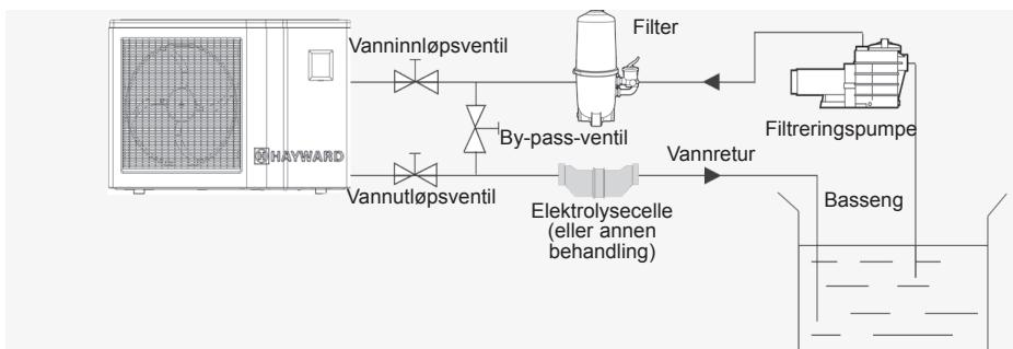
Merk: Varmepumpen leveres uten noe rense- eller filtreringsutstyr.
