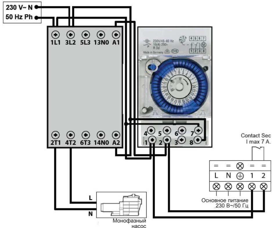
Разъемы 1 и 2 обеспечивают подачу питания на бесполярный контакт при напряжении 230 В 50 Гц. Подключите кабели к разъемам 1 и 2 в соответствии с указанной монтажной схемой для автоматической регулировки насоса фильтрации по циклам в 2 минуты каждый час, когда температура резервуара снижается ниже установленного значения.
