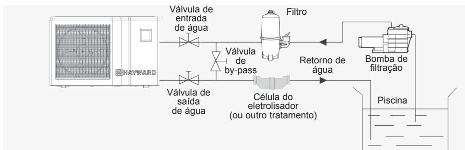
Nota: \_a bomba de aquecimento é fornecida sem qualquer equipamento de tratamento ou de filtração. Os elementos que constam do esquema são componentes a fornecer pelo instalador.
