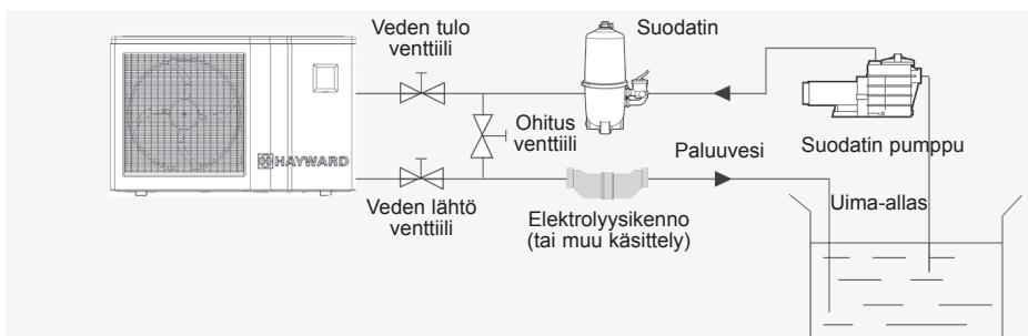
Huomaa: Lämpöpumppu toimitetaan ilman veden käsittely- tai suodatuslaitteita. Asentajan on hankittava kaaviossa esitetyt osat.
