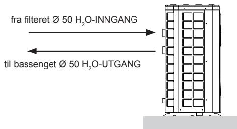
Installere en såkalt "by-pass"-ventil mellom varmepumpens innløp og utløp.
