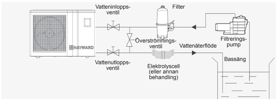
Anmärkning: \_Värmepumpen levereras utan någon behandlings- eller filtreringsutrustning. Elementen som visas på schemat är delar som installatören måste tillhandahålla.
