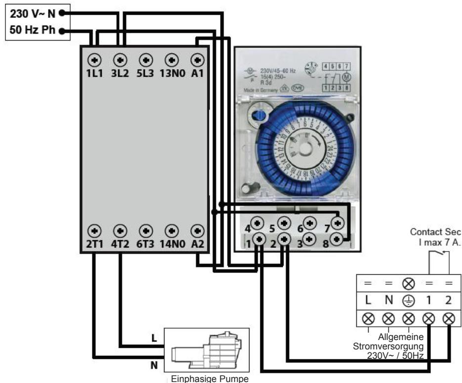
Außerhalb des Filter-Bereichs muss eine Wassertemperatur-Abfrage mittels regelmäßigem Start der Filterpumpe (15 Minuten alle 2 Stunden) erfolgen). Falls die Wärmepumpe in diesem Abfragezeitraum einen Bedarf hat, wird diese mit der Vorrangstellung für die Heizung starten und dies beibehalten.
