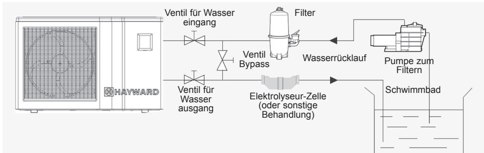
Anmerkung: Die Wärmepumpe wird ohne Behandlungs- und Filter-Element geliefert. Bei den auf dem Schema dargestellten Teilen handelt es sich um Bestandteile, die der Monteur zu liefern hat.
