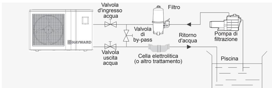
Nota: La pompa di calore viene fornita priva di dispositivo di trattamento o di filtrazione. I componenti indicati sullo schema sono forniti dall'installatore.
