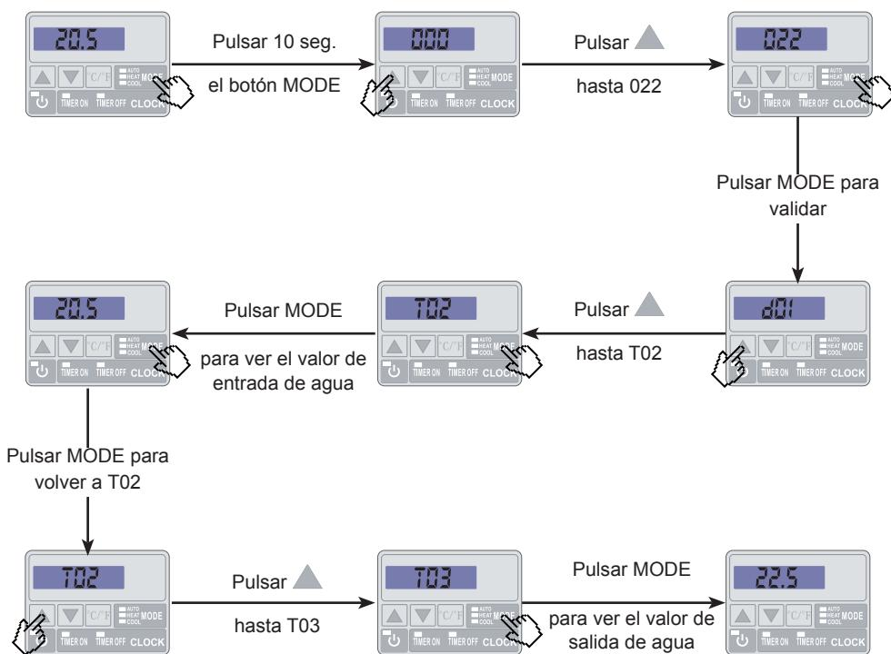
A continuación, ajuste la válvula de derivación de forma que obtenga una diferencia de 2°C entre T03 y T02 ( $T03 - T02 = \Delta T = 2$ ).
