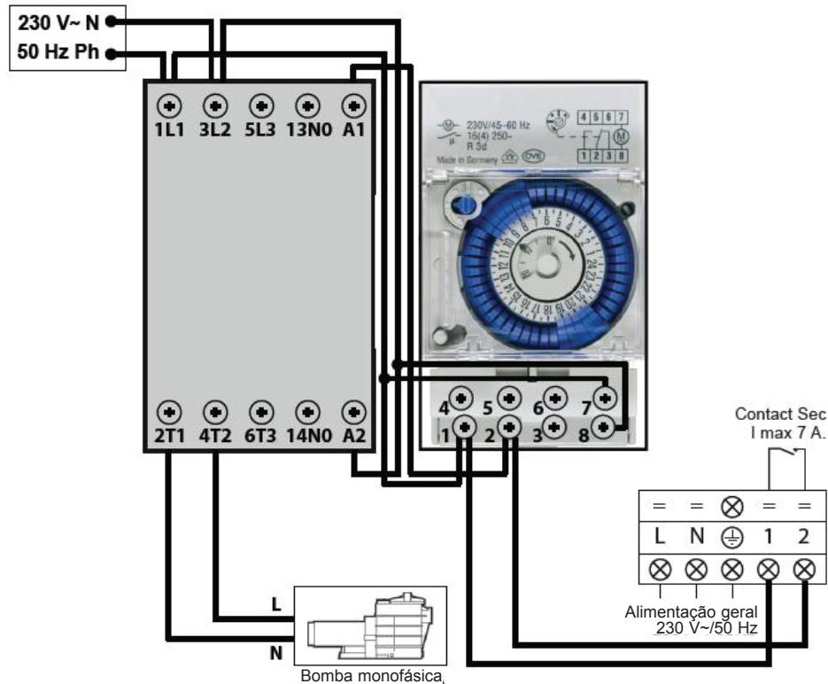
Os terminais 1 e 2 emitem um contacto seco livre de potencial, sem polaridade de 230 V~/ 50 Hz. Cablar os terminais 1 e 2 respeitando a cablagem indicada acima, a fim de controlar o funcionamento da bomba de filtração por ciclo de 2 minutos todas as horas se a temperatura da bacia for inferior ao ponto recomendado.
