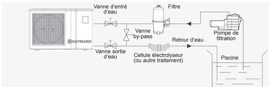
Note : La pompe à chaleur est fournie sans aucun équipement de traitement ou de filtration. Les éléments présentés sur le schéma sont des pièces à fournir par l'installateur.
