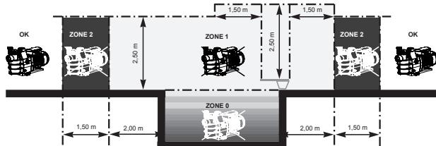
Installer la pompe dans un local ventilé et sec, le moteur exige que l'air circule librement autour de celle-ci pour permettre sa ventilation naturelle.
