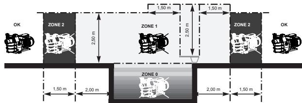
Die Pumpe in einem belüfteten und trockenen Raum aufstellen. Der Motor macht eine ungehinderte Luftzirkulation erforderlich.
