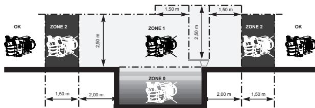
Instalar la bomba en un local ventilado y seco, el motor requiere que el aire pueda circular libremente a su alrededor para que se ventile de forma natural.
