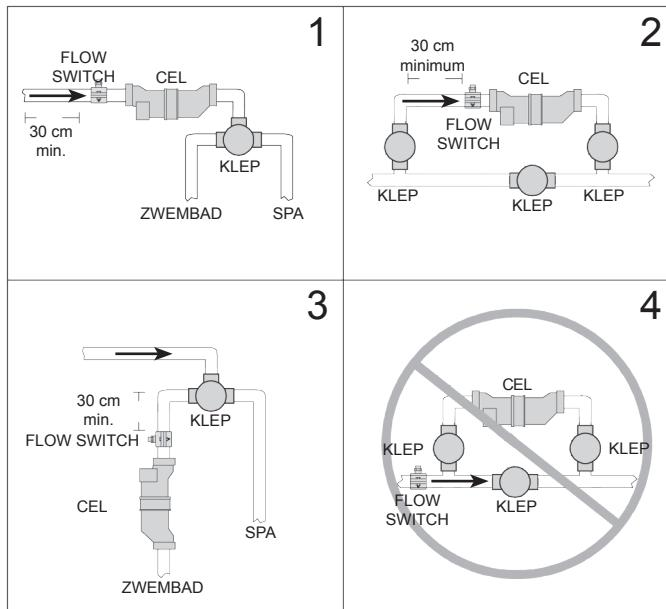
**BELANGRIJK:** Er moet een rechtlijnige deel buis van minimaal 30 cm boven de 'flow switch' geplaatst worden. Dit moet voor de cel geïnstalleerd worden. Controleer voor een correcte werking of de pijl op de schakelaar (bovenaan de grijze zeshoek) in de richting van de stroming wijst.
