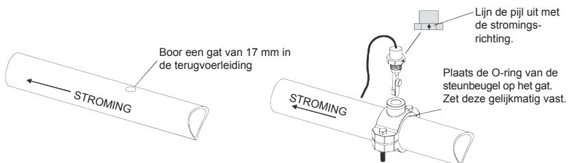
**Cel:** Bevestig de cel met de meegeleverde aansluitstukken. Draai de moeren **MET DE HAND** vast voor een volledige dichtheid. Voor gecombineerde zwembad/spasystemen met overloop, gebruikt u configuratie 2 of 3, om een superrdosering van chloor voor de spa te vermijden.
