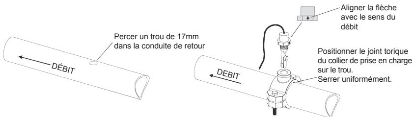
**Cellule :** Fixer la cellule avec les raccords fournis. Serrer les écrous **A LA MAIN** pour assurer une étanchéité totale. Pour les systèmes combinés piscine/spa avec débordement, utiliser la configuration 2 ou 3, pour ne pas créer un surdosage en chlore en fonction spa.
