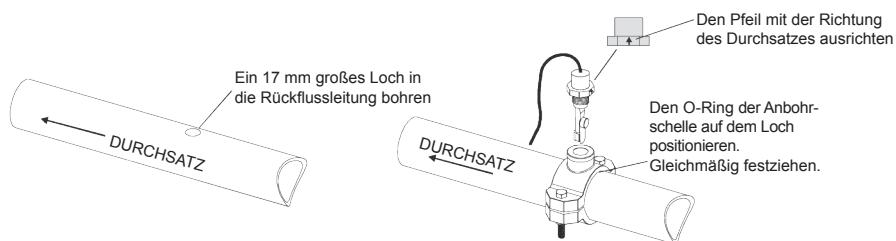
**Zelle:** Die Zelle mit den mitgelieferten Anschlässen befestigen. Die Bolzen **PER HAND** festziehen, um eine perfekte Dichtung zu gewährleisten. Bei kombinierten Systemen Schwimmbecken / Spa mit Überlauf die Konfiguration 2 oder 3 nehmen, um keine Überdosierung des Chlors in Abhängigkeit des Spas hervorzurufen.
