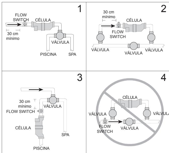
**IMPORTANTE:** Una parte rectilínea de al menos 30 cm de tubo debe colocarse hacia arriba del "Flow Switch". Éste debe instalarse antes de la célula. Para garantizar un funcionamiento correcto, comprobar que la flecha sobre el contactor (situada en la cumbre del hexágono gris) esté orientada en dirección del caudal.
