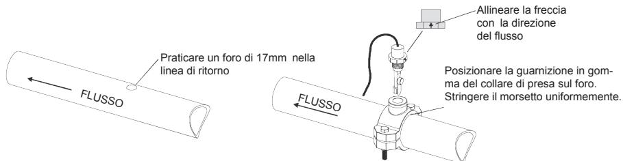
**Cella:** Fissare la cella utilizzando i raccordi in dotazione. Avvitare **MANUALMENTE** i dadi per assicurare la completa ermeticità. Nei sistemi combinati piscina/idromassaggio a straripamento utilizzare la configurazione 2 o 3 per non creare un'eccessiva produzione di cloro in modalità idromassaggio.
