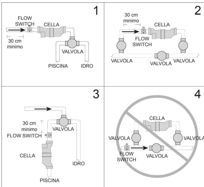
**IMPORTANTE:** Collocare un tubo diritto, lungo almeno 30 cm, a monte del "Flow Switch". Quest'ultimo deve essere installato prima della cella. Per assicurare un corretto funzionamento, verificare che la freccia del contatore (posta sulla sommità dell'esagono grigio) sia rivolta nel senso del flusso.
