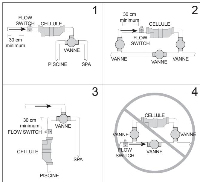
**IMPORTANT :** Une partie rectiligne d'au moins 30 cm de tuyau doit être placée en amont du "Flow Switch". Celui-ci doit être installé avant la cellule. Pour assurer un fonctionnement correct, vérifier que la flèche sur le contacteur (située au sommet de l'hexagone gris) soit orientée dans le sens du débit.
