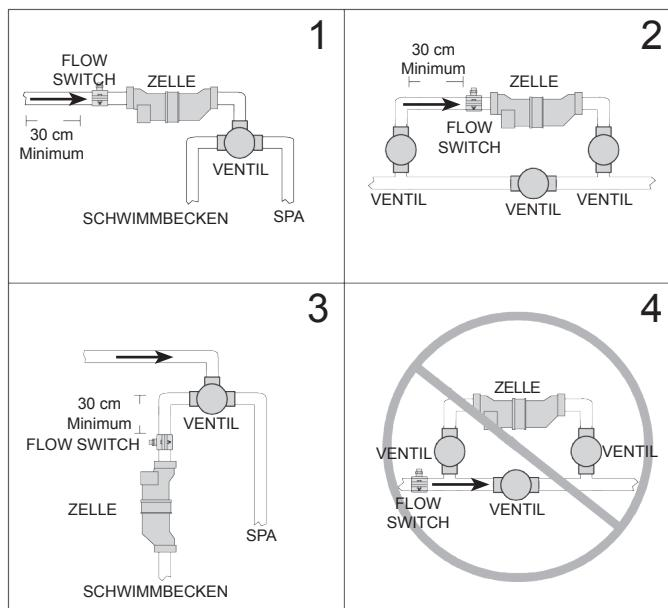
**WICHTIG:** Vor den "Flow Switch" muss ein mindestens 30 cm langer, geradliniger Teil des Rohrs vorgeschaltet werden. Dieser Teil muss vor der Zelle installiert werden. Zur Gewährleistung eines ordnungsgemäßen Betriebes überprüfen, dass der Pfeil auf dem Kontaktgeber (auf der Spitze des grauen Sechsecks) in Durchflussrichtung ausgerichtet ist.
