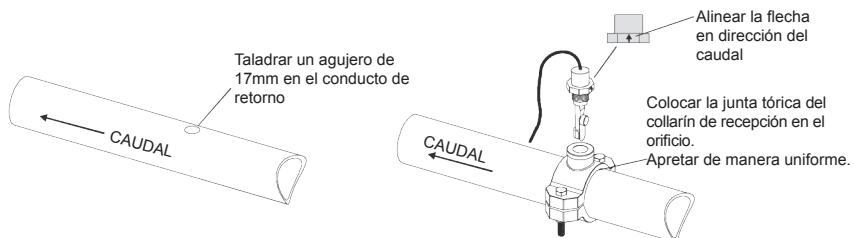
**Célula:** Fijar la célula con los empalmes proporcionados. Apretar las tuercas **A MANO** para garantizar una buena estanqueidad. Para los sistemas combinados piscina/spa con desbordamiento, utilizar la configuración 2 ó 3, para no crear una sobredosis de cloro en función spa
