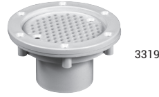
Einstellbare Einlaufdüse 2" Schraubanschluss und 63er Klebanschluss für Beton- und Folienbecken
