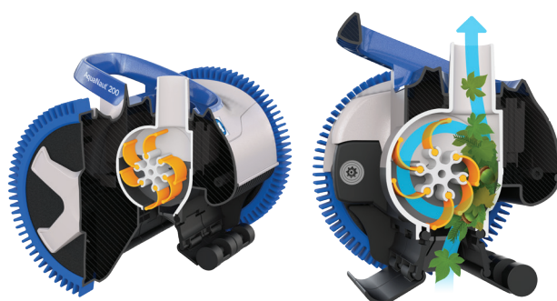
Tecnologia brevettata V-Flex®: turbina a pale mobili per l'aspirazione di detriti grandi
