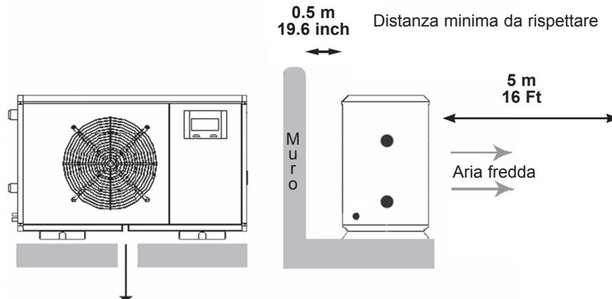
Prevedere un basamento sufficientemente rigido e un'evacuazione della condensa (acqua).
