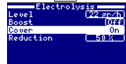
11.2 Reduktion af klorproduktionen i procent, når svømmebassinets poolcover er lukket. Når poolcoveret er lukket, behøver systemet ikke fungere 100 %. Denne parameter gør det muligt at indstille den optimale klorproduktion.
