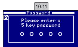
10.11 Adgangskode: Gør det muligt at beskytte adgangen til brugermenue med en adgangskode. For at angive adgangskoden, tryk på en kombination af 5 taster. Systemet gemmer adgangskoden. Hvis du glemmer adgangskoden, findes der en "hovedadgangskode". Kontakt din installatør/forhandler.
