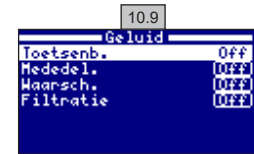
10.9 Geluid: Programmering van het systeem dat geluiden voortbrengt voor de volgende functies: Toetsenb. (toetsen), Mededel. (urgente berichten), Waarschuw. (alarm), Filtratie (start filtratie).
