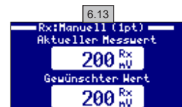
6.13 Ohne die Sonde aus dem Wasser zu nehmen, korrigieren Sie mit den Tasten MEHR/WENIGER den angezeigten Messerwert, bis er mit dem Referenzwert übereinstimmt (Fotometer oder anderes Messgerät).
