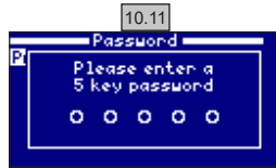
10.11 Passord: Gjør det mulig å beskytte tilgangen til brukermenyen med et passord. For å angi passord, trykk på en kombinasjon av 5 taster. Systemet lagrer passordet. Hvis du glemmer passordet, finnes det et «hovedpassord». Ta kontakt med din installatør/forhandler.
