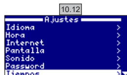
10.12 Tiempos: Contadores de horas de funcionamiento de los diferentes módulos.
