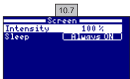
10.7 Inställning av skärmens ljusstyrka (0-100 %) och skärmens av/påslagning.
