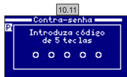
10.11 Senha: Permite proteger o acesso ao menu do utilizador com uma senha. Para inserir a senha, premir uma combinação de 5 teclas, que o sistema memorizará. Se não se lembrar da senha, existe uma "senha mestra". Contactar o instalador/fornecedor.
