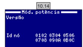
10.14 Informações do sistema: Informações sobre a versão de software do ecrã TFT disponível e o módulo de potência. Mostra também a identificação de nó necessária para configurar a ligação do sistema ao Wi-Fi.
