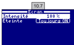
10.7 Réglage de l'intensité de l'éclairage de l'écran (0-100 %) et programmation de l'allumage/extinction de l'écran.
