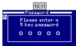
10.11 Lösenord: För att skydda användarmenyen med lösenord. Välj lösenord genom att trycka på en kombination av 5 knappar. Systemet sparar kombinationen. För ifall att du skulle glömma ditt lösenord finns det ett "huvudlösenord". Kontakta då installatör/leverantör.
