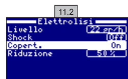
11.2 Riduzione della produzione di cloro in percentuale, quando la copertura della piscina è chiusa. Con la copertura chiusa non è necessario che il sistema funzioni al 100%. Con questo parametro, viene regolata la quantità ottimale di produzione di cloro.
