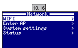
10.16 WiFi: Vælg WiFi for at vise de netværke, der er tilgængelige for modulen. Søgningen udføres automatisk.
