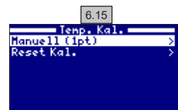
6.15 Manuelle Kalibrierung: zur Einstellung der Sonde auf 1 Punkt.
