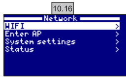
10.16 WiFi: Velg WiFi for å vise nettverkene som er tilgjengelige for modulen. Søket utføres automatisk.
