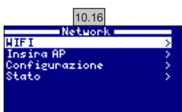
10.16 WIFI: Selezionare Wi-Fi per ricercare le reti disponibili accessibili al modulo. Verrà eseguita la ricerca automaticamente.
