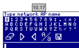
10.17 Das gewünschte Netzwerk auswählen. Geben Sie das Passwort mithilfe der Tastatur im Pop-up-Fenster ein. Drücken Sie die Tasten nach oben/nach unten, um den Cursor nach oben oder nach unten zu bewegen, sowie die Tasten MEHR/WENIGER, um den Cursor nach links und rechts zu bewegen. Um einen Buchstaben auszuwählen, drücken Sie OK.
