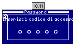
10.11 Password: Permette di proteggere l'accesso al menù utente attivando una password. Per inserire il codice di accesso premere una combinazione di 5 tasti e il sistema la memorizzerà. Se la password viene dimenticata, è prevista una "password master". Chiedere all'installatore/fornitore.
