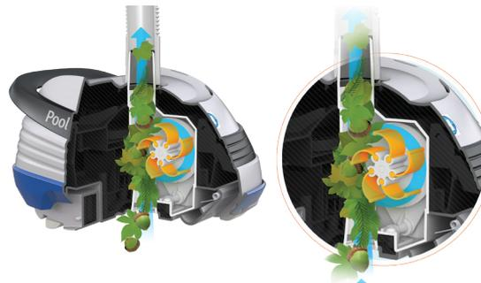
Patenterte Technologie V-Flex®: Turbine mit flexiblen Turbinenblätter für die Aufnahme großer Verunreinigungen
