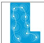
Sistema de guiado automático AquaPilot, para cubrir el conjunto de la piscina. Su desplazamiento en espiral hace que nunca se queda bloqueado
