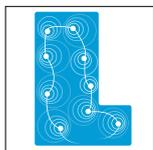
Système de guidage automatique breveté SmartDrive qui couvre l'ensemble du bassin. Son déplacement en spirales lui permet de ne jamais rester bloqué.
